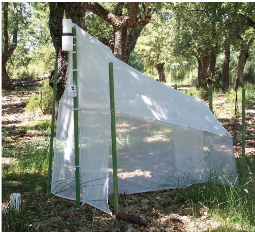
Figura 4: Trampa Malaise en un hábitat de bosque para la captura de insectos voladores. Foto: M. A. Marcos García.
